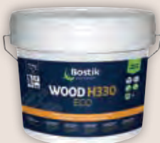
Art.-Nr. 70050 BOSTIK WOOD H330 ECO KLEBSTOFF Lösemittelfreier Einkompo- nenten Klebstoff für die elastische Verklebung von Mosaikparkett und Mehr- schichtparkett bis 250 cm Dielenlänge. Verbrauch mit B11 = 1000-1200 g/m 2 . Eimer à 17 kg = ausreichend für ca. 14-17 m 2
