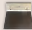
Art.-Nr. 70054 WITTE KLEBE- SPACHTEL 18 cm B11, grobe Riffelung, Zahnbreite 7,9 mm, Lückenbreite 6,1 mm, Lückentiefe 5,0 mm für 3-Schicht-Parkett. Sollte alle 30 m 2 ausgetauscht werden.
